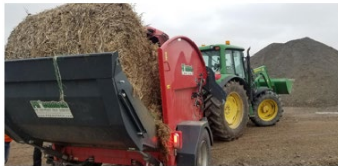
Photo : sur la phase 2, WM a recouvert les matières avec de la paille injectée avec un neutralisant d'odeurs
