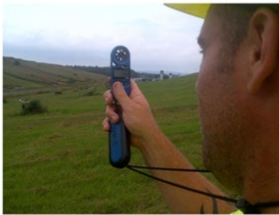
Photo : prise de données géoréférencées des émissions fugitives de biogaz
